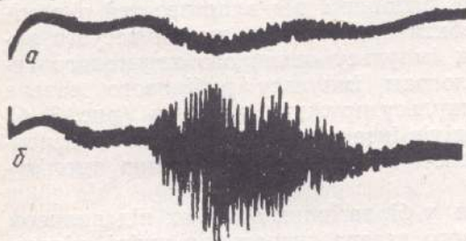
Рис. 4. Пружні коливання, викликані випроміненням імпульсного рубінового лазера в алюмінієвій пластинці:
