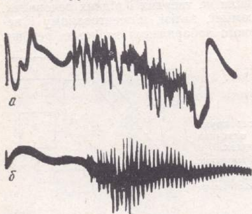
Рис. 2. Осцилограми випромінення рубінового лазера (а) та викликані ним у м'язовій тканині пружні коливання (б).
